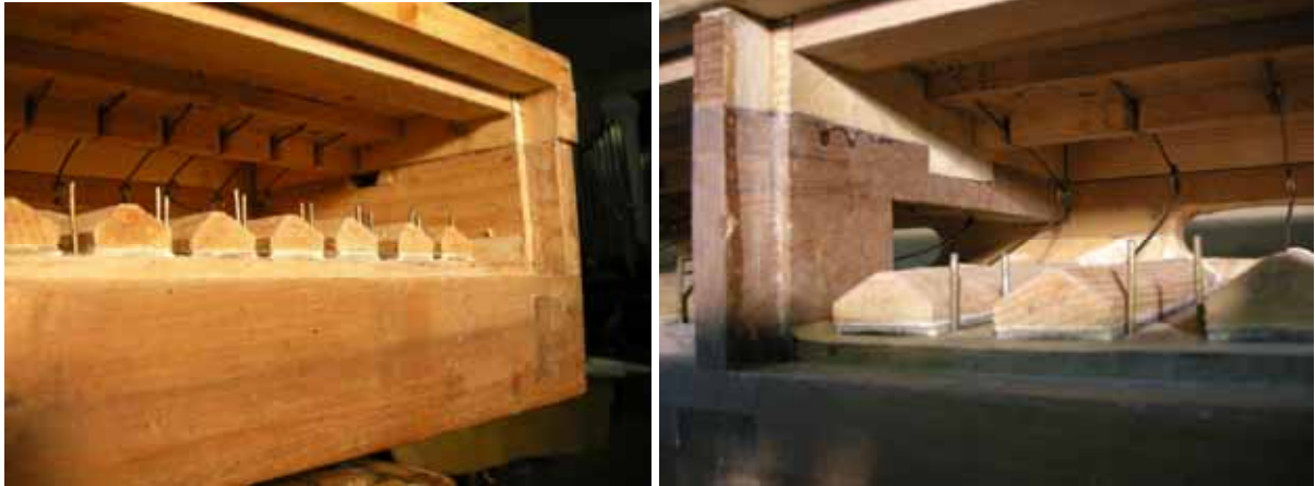
Zustand der Windladen vor der Restaurierung. Deutlich erkennbar die Aufdoppelungen und Veränderungen.
